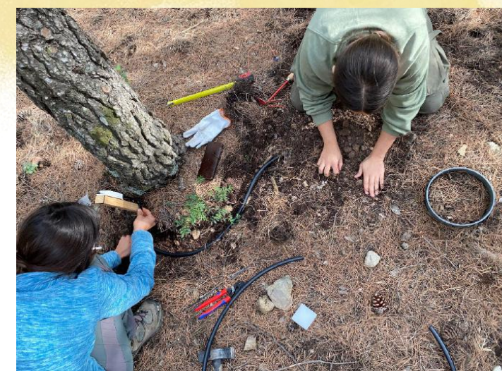
Instalación de equipos para medición de flujos de carbono en el suelo.
