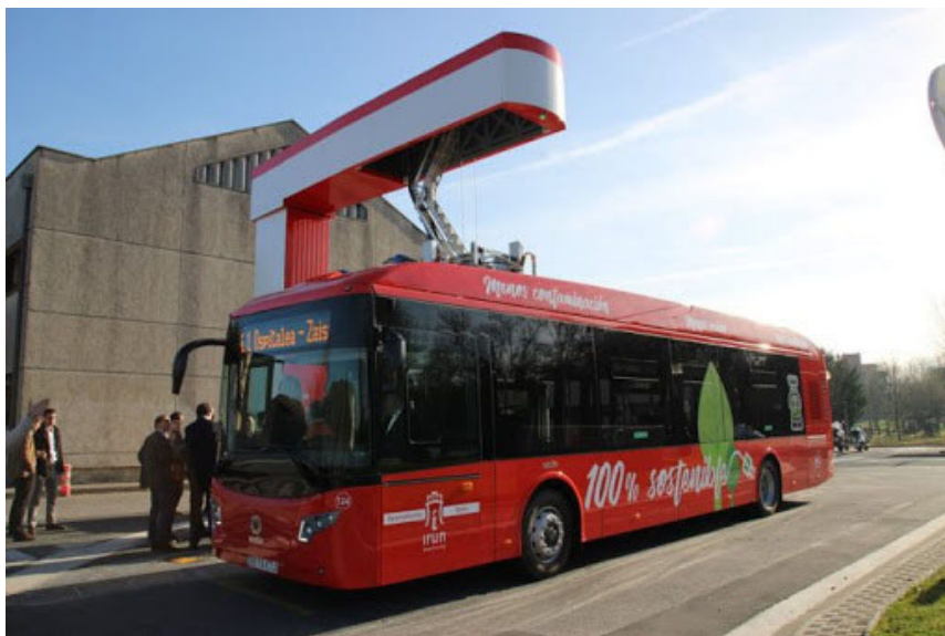
Ilustración 24: Carga de Oportunidad por pantógrafo (Transportes de Irún) 34
