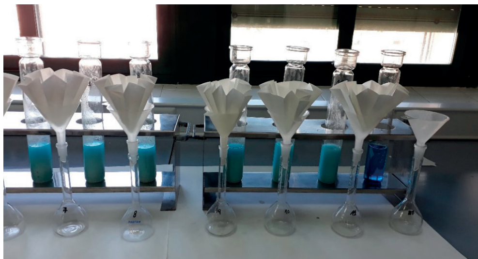
Figura 34. Determinación del nitrógeno total del suelo a partir de método de Kjeldahl (Bremer, 1996). Imagen propia.
