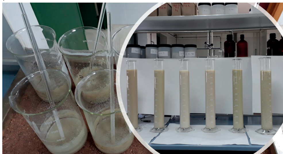
Figura 32. Determinación de la textura del suelo. Imagen propia.
