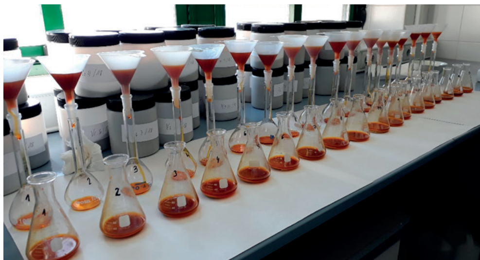
Figura 33. Determinación del Carbono orgánico del suelo a partir del método Walkley y Black (Nelson y Sommers, 1982). Imagen propia.
