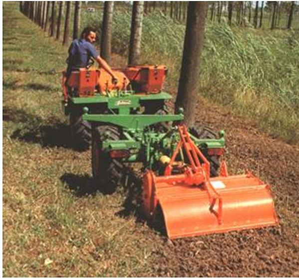
FIGURA 1.23. TRACTOCARRO TIPO “TRANSPORTADOR” CON 4 RUEDAS MOTRICES
