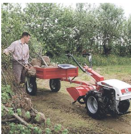
FIGURA 1.22. TRACTOCARRO TIPO "ESTÁNDAR" DERIVADO DE UN MOTOCULTOR CON 4 RUEDAS MOTRICES (ELEMENTOS NO SEPARABLES)
