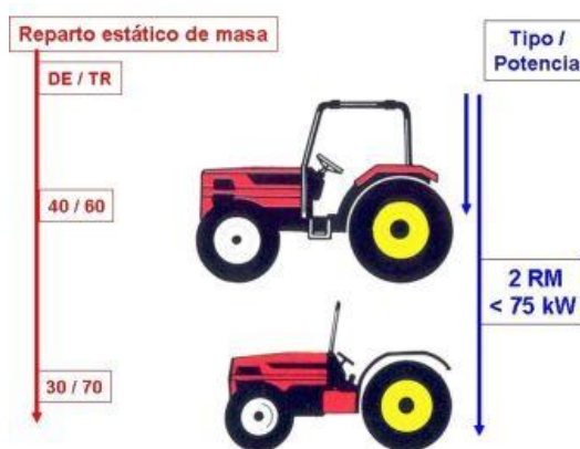
FIGURA 1.1. TRACTOR AGRÍCOLA DE DOS RUEDAS MOTRICES
