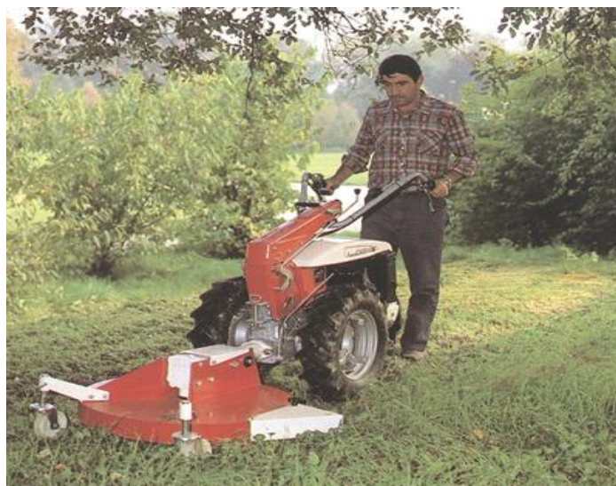
FIGURA 1.19. UTILIZACIÓN COMO SEGADORA-DESBROZADORA
