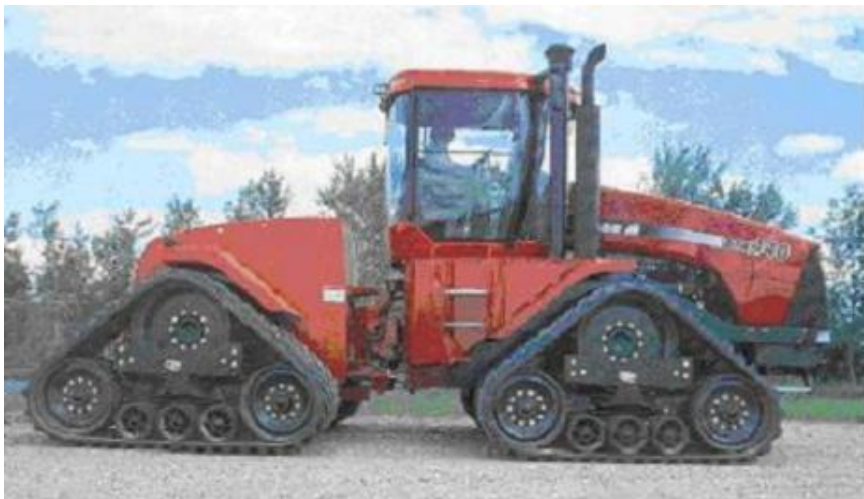
FIGURA 1.7. TRACTOR DE BANDAS DE GOMA ARTICULADO CON 4 PROPULSORES
