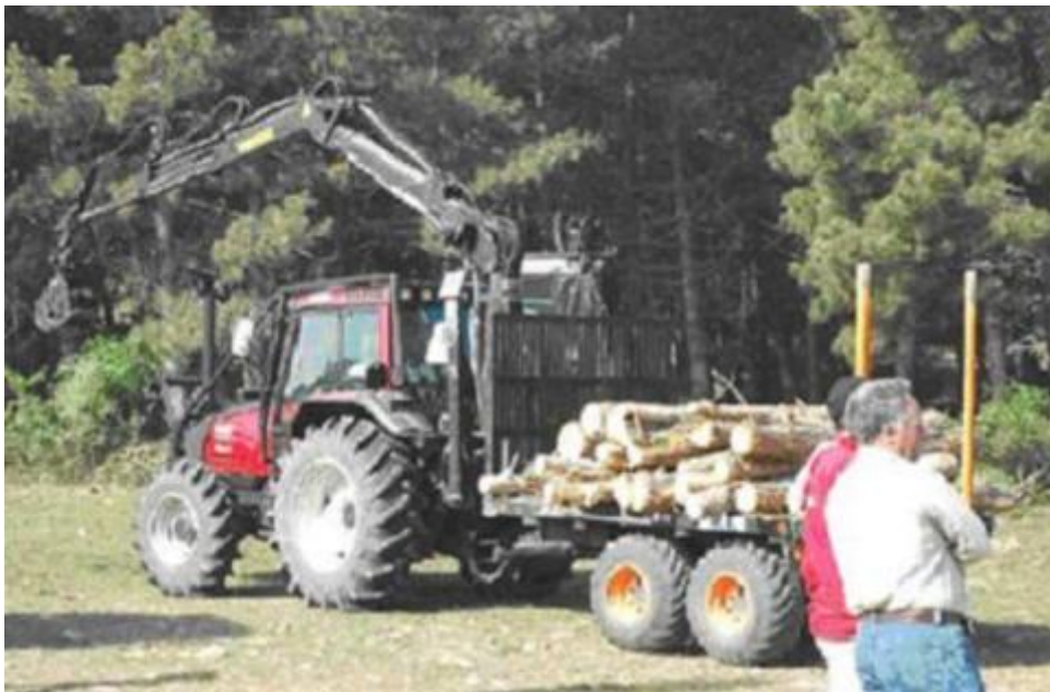
FIGURA 1.15. TRACTOR AGRÍCOLA TRANSFORMADO PARA UTILIZACIÓN FORESTAL
