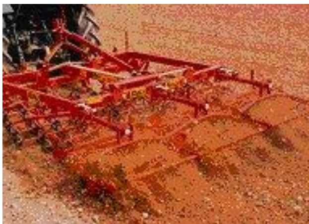
FIGURA 1.45. VIBROCULTOR (LABOREO SECUNDARIO)
