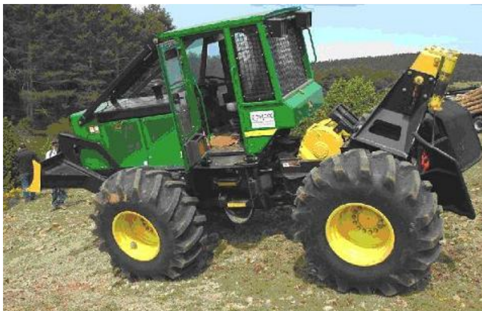
FIGURA 1.10. ARRASTRADORES (SKIDDERS) CON CABLE
