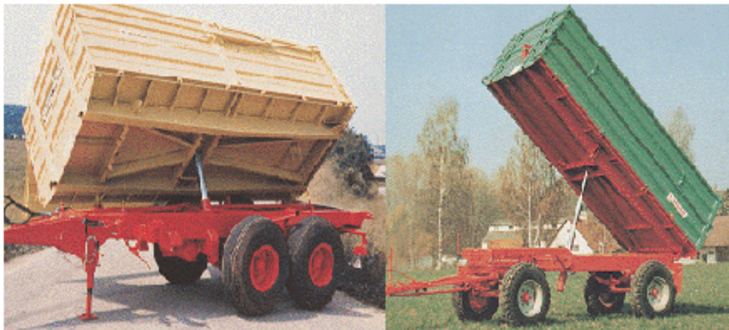
FIGURA 1.41. REMOLQUE AGRÍCOLA BASCULANTE HACIA ATRÁS DE DOS EJES Y REMOLQUE AGRÍCOLA BASCULANTE LATERAL CON EJE TANDEM Y CARGA VERTICAL SOBRE LA LANZA
