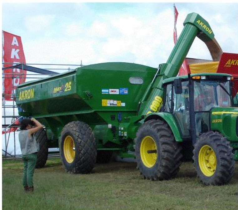
FIGURA 1.42. REMOLQUE-TOLVA PARA EL TRANSPORTE Y MANEJO DE GRANOS
