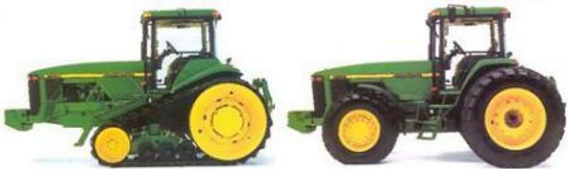
FIGURA 1.5. TRACTOR DE BANDAS DE GOMA DERIVADO DE UN TRACTOR DE RUEDAS
