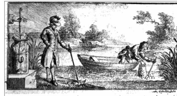
Matériel de collecte et d'analyse des gaz des marais utilisés par Volta 2 en 1778
